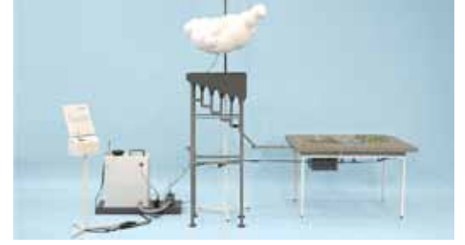
Şekil 8. Su meydanı çalışma prensibini gösteren model.
