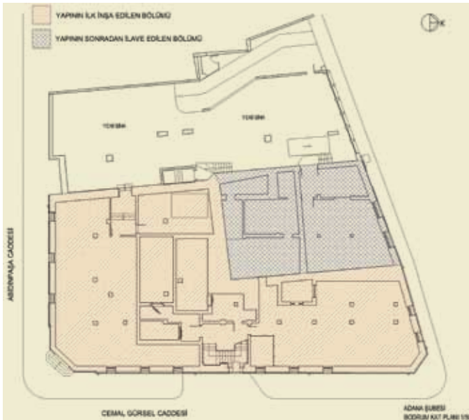
Resim 12. Yapının inşaat aşamaları.
