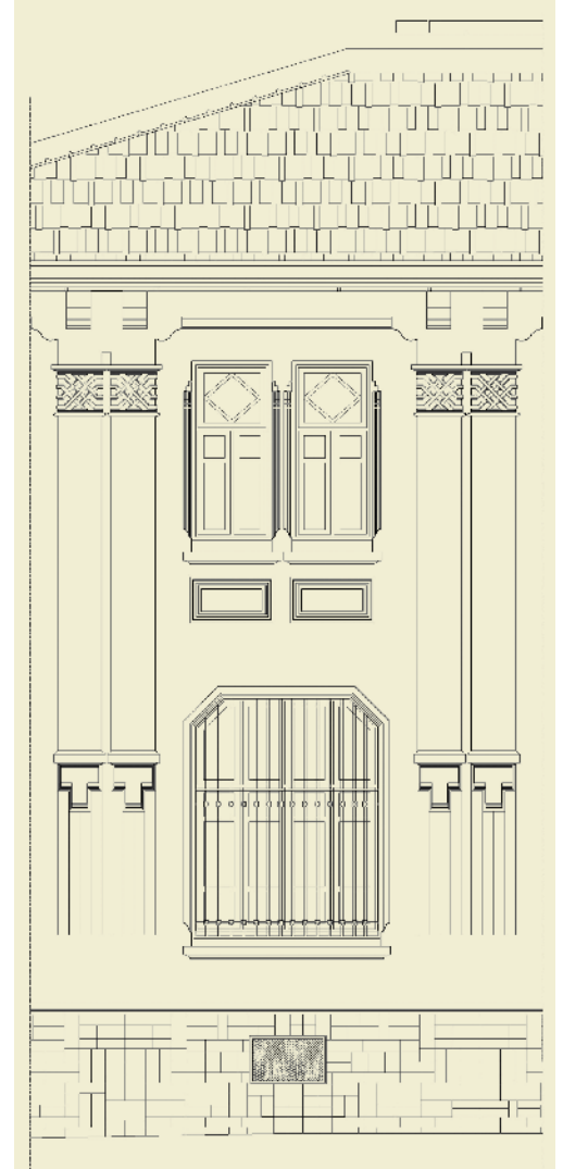
Resim 22a. Güney cephedeki manierist pilastrlar.
