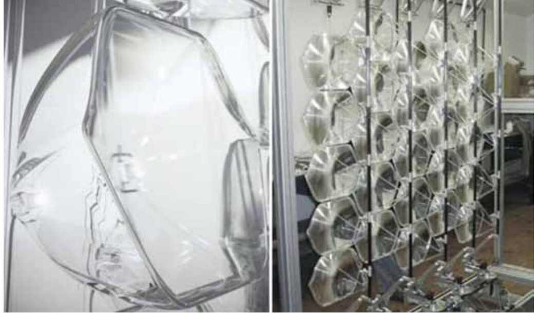
Şekil 3. Entegre yoğunlaştırılmış dinamik güneş sistemi prototipi. (Wang, 2010)
