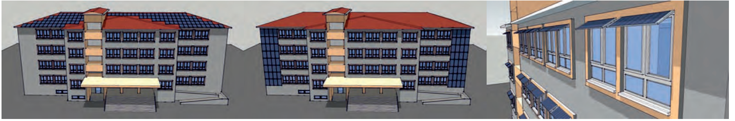
Çatı kaplaması olarak önerilen FV paneller
